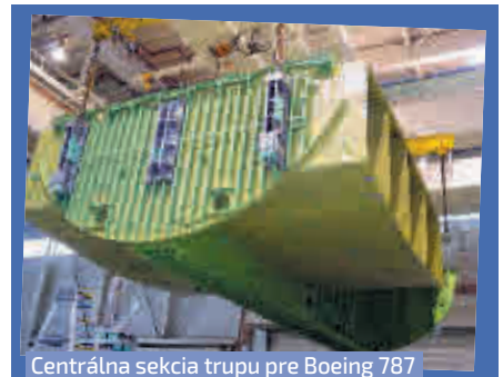
Centrálna sekcia trupu pre Boeing 787 obsahuje najdôležitejšie prvky elektroniky a hydrauliky, vrátane ovládania podvozku.
