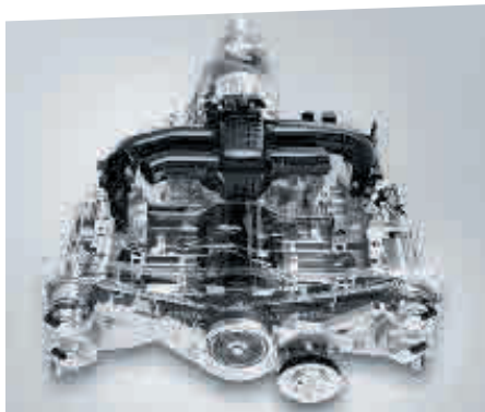
V horizontálne uloženom motore boxer sa symetricky rozmiestnené piesty pohybujú oproti sebe, čím vzájomne kompenzujú zotrvačné sily.
